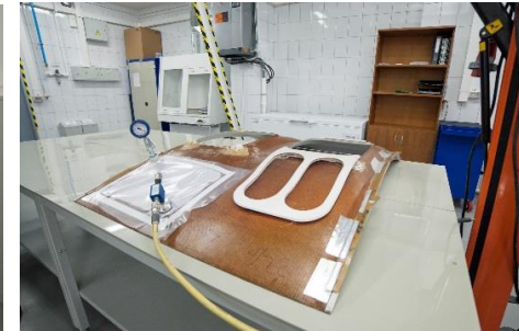
Участок ремонта конструкции и композитных материалов
