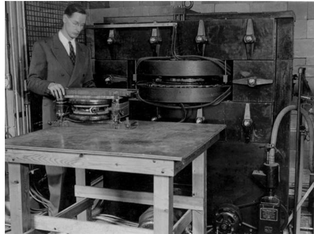
*В США и Канаде применялись бетатроны с энергией 13–25 МэВ, а также высоковольтные трансформаторы и генераторы Ван-де-Графа с номинальной энергией тормозных фотонов 1–4 МэВ*
