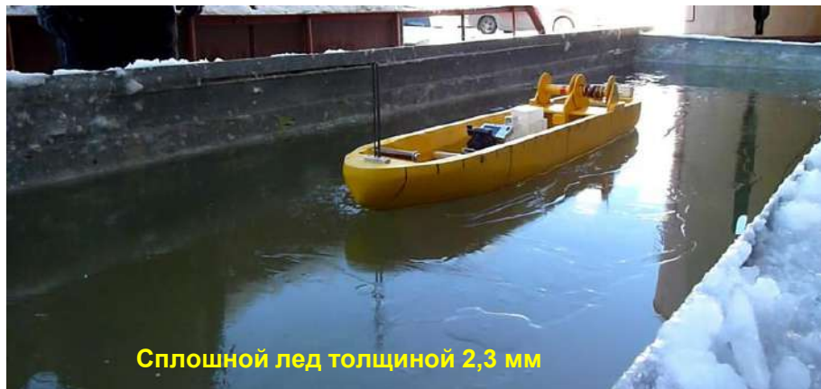
Пример модельных испытаний судна ледового класса Icebreaker 8 пр.00902 в сплошном льду
